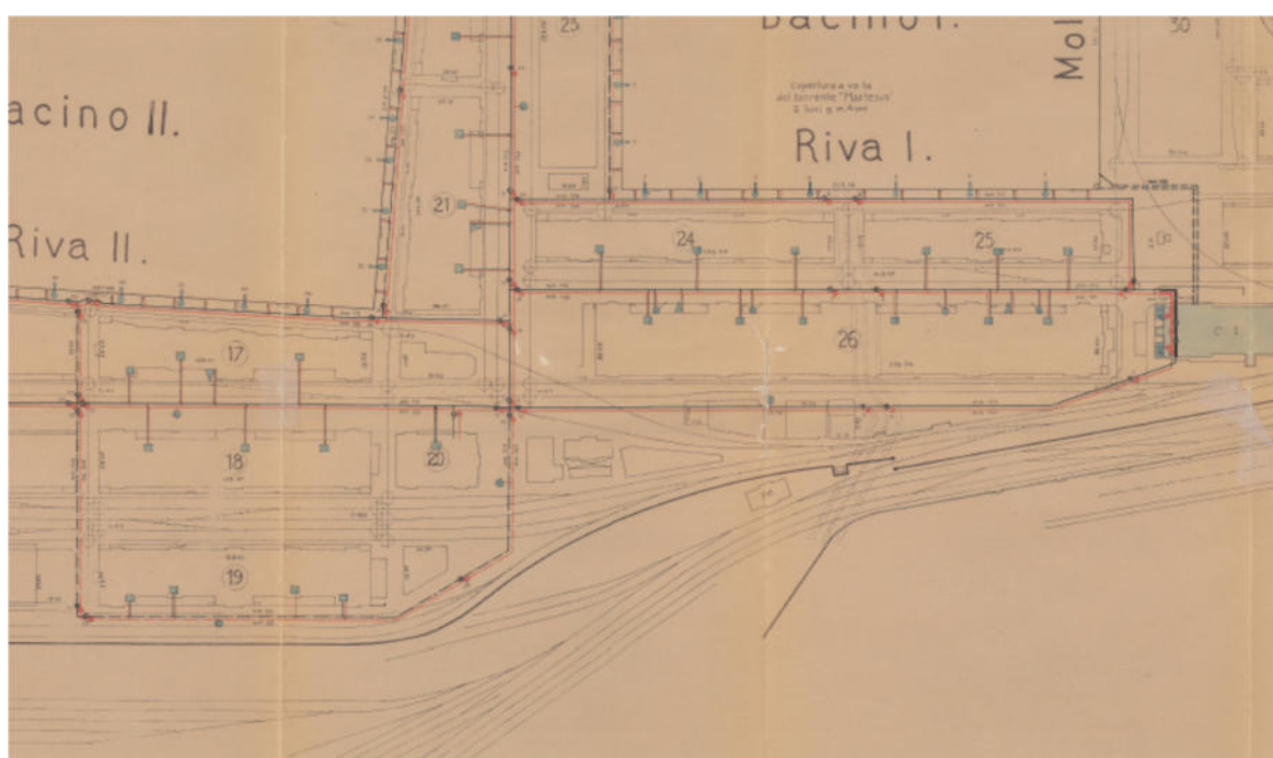
Fig. 9.2 – Planimetria storica (1933-35) della situazione impianti idrodinamici nell'area di intervento
