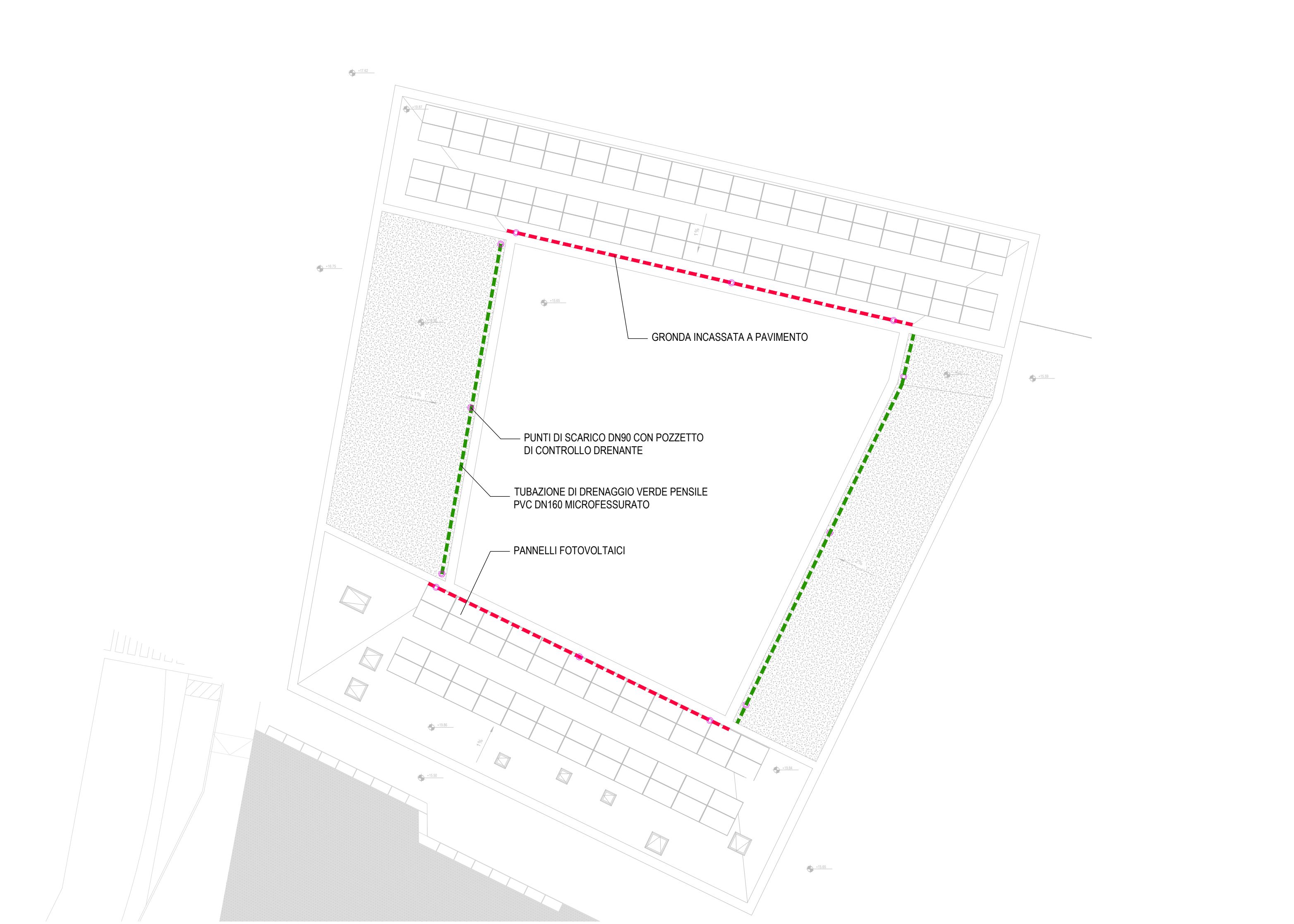
Planimetria rete acque meteoriche copertura asilo scala 1:200
